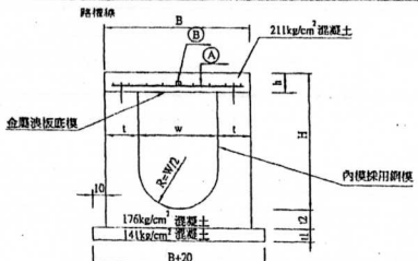
U型暗溝斷面圖 S=1:20
