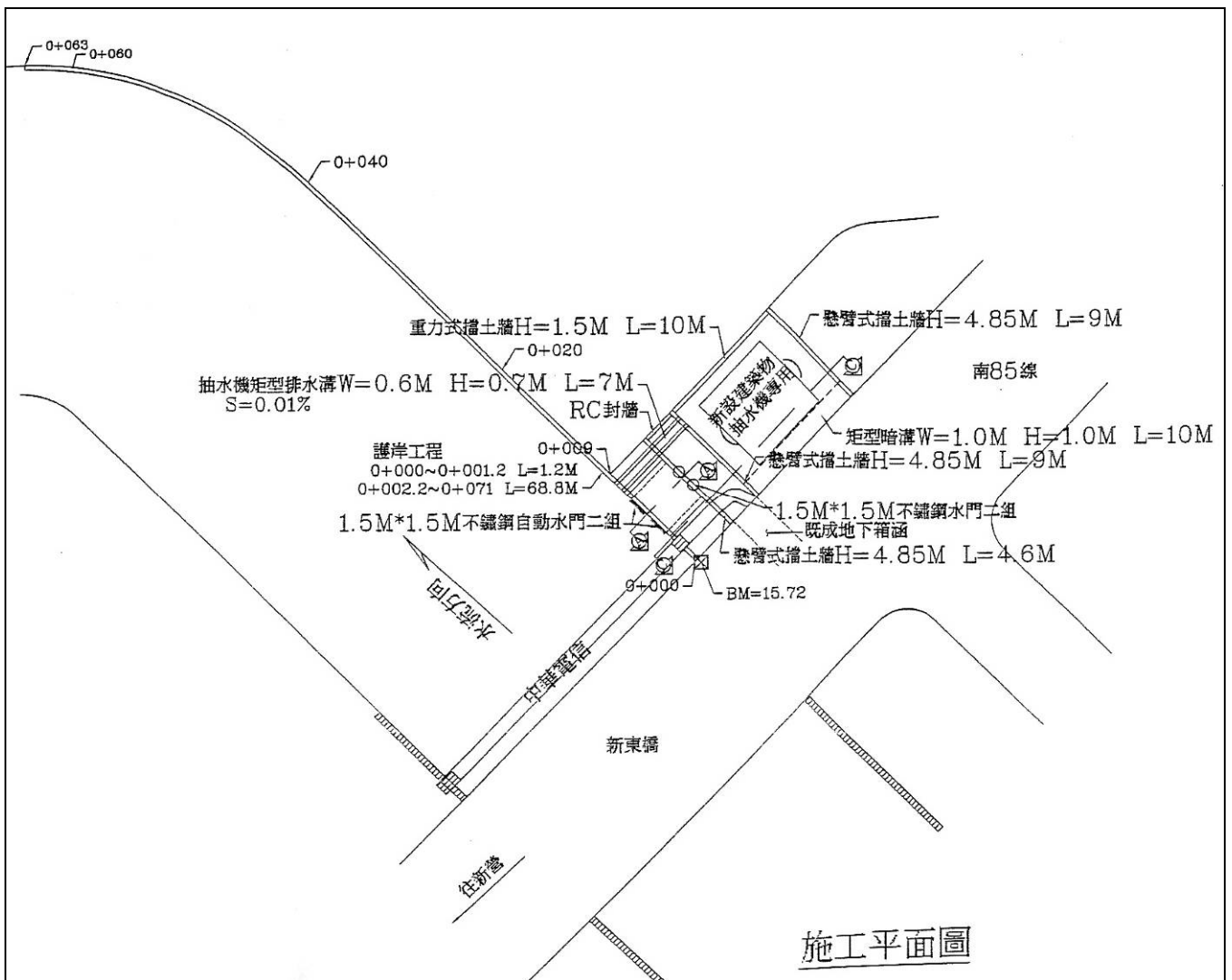
圖7-3-4 新東村新港東排水出口改善施工平面圖
