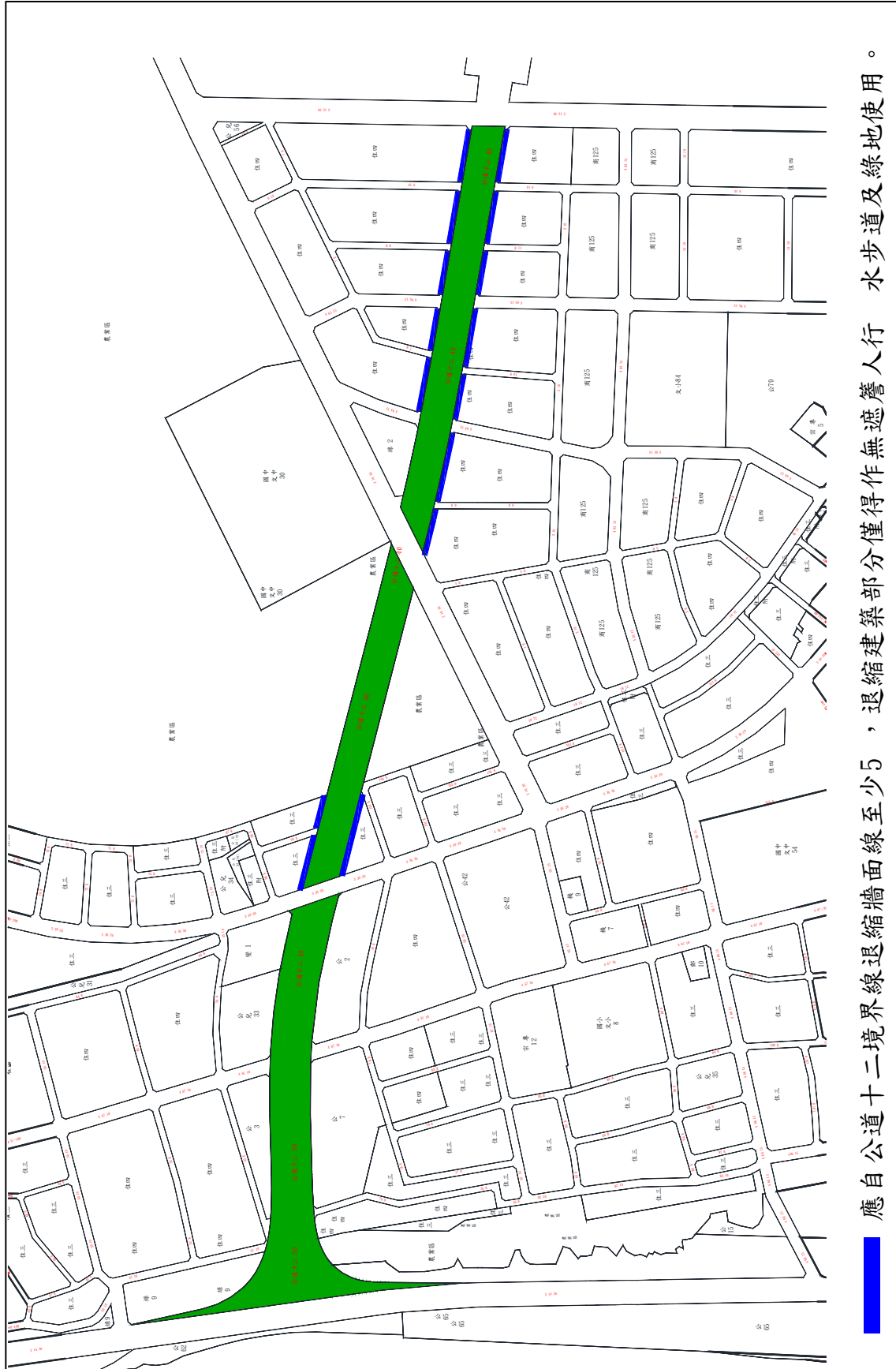
圖六-3 公道十二（台 86 東西向 速道路）兩側建築基地退縮建築位置示意圖
