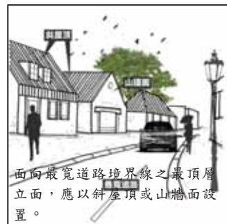
土管圖 7 面向最寬道路境界線立面示意圖
