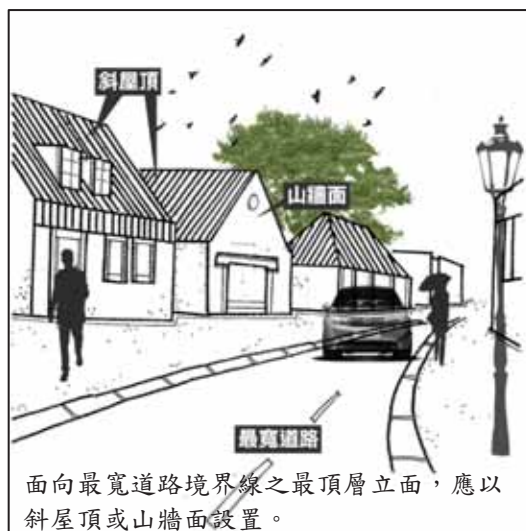
圖 7-10 面向最寬道路境界線立面示意圖
