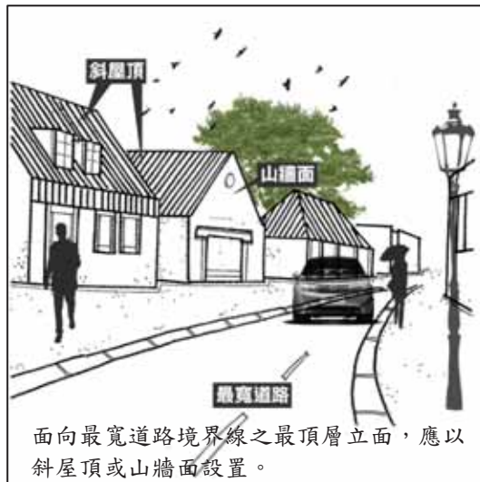
圖 2-14 面向最寬道路境界線立面示意圖
