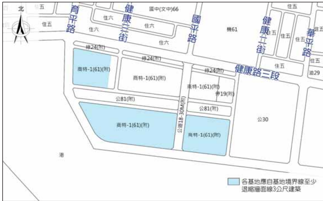
圖 7-13 指定街廓鄰棟間隔限制示意圖
