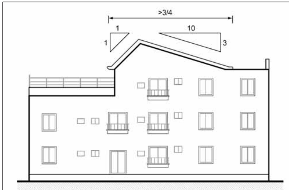
圖 2-36 斜屋頂斜面坡度底高比示意圖
