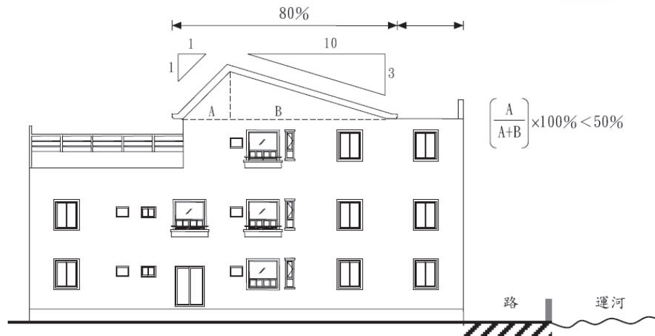
附圖十四 斜屋頂斜面坡度示意圖
