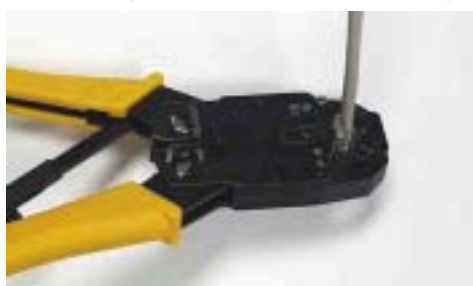
圖 9-29 壓接電纜與資訊插頭
