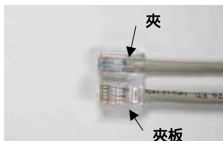
圖 9-28 心線前緣皆應碰到凹槽的底邊
