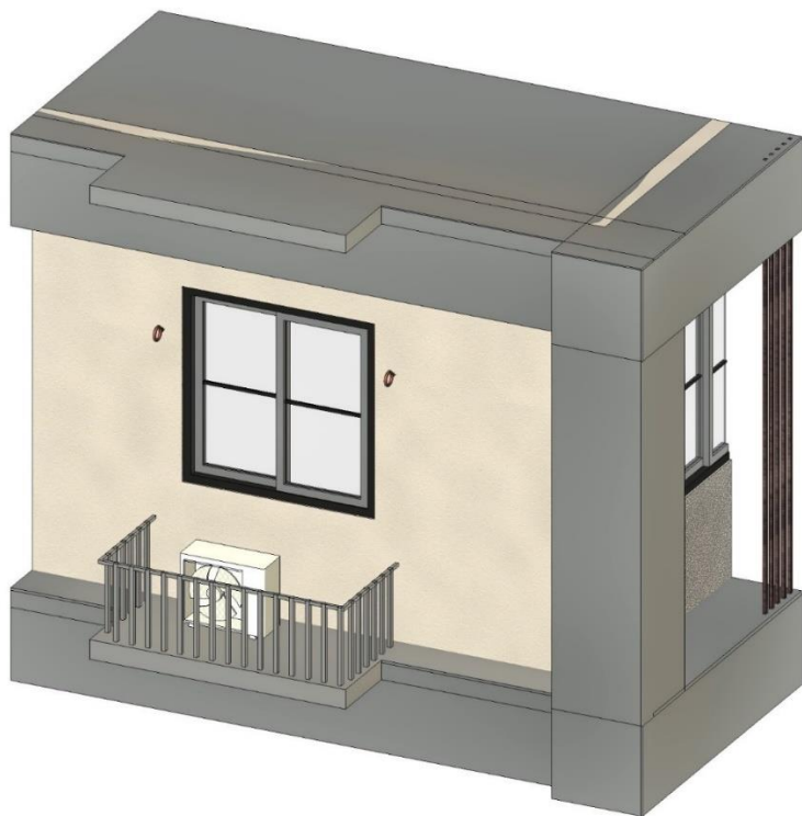
圖 2-1、雨遮設置室外機範例
